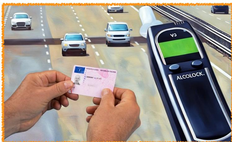
Funziona sostanzialmente come un etilometro poiché il conducente del veicolo, prima di accendere la macchina, deve soffiare nell'apparecchio. Se viene rilevato un tasso alcolemico nel fiato, la macchina praticamente non parte. I codici sono apposti dal prefetto, il quale dispone, altresì, la revisione della patente di guida. Per intenderci, sia nell'ipotesi in cui sia apposto il codice 68 sia in quella in cui sia apposto il codice 69 il veicolo deve essere dotato dell'apparecchio alcolock.
